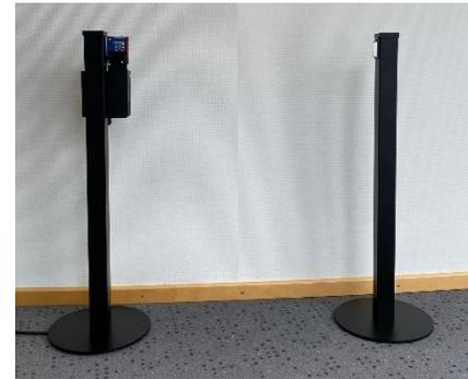
Am Ausgang befindet sich eine Lichtschranke mit Funkverbindung zur Steuerung. Der Spiegel für die Lichtschranke befindet sich ebenfalls auf der gegenüberliegenden Seite der Türe.
