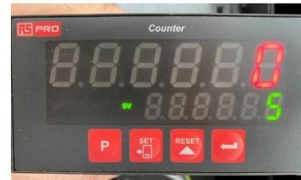
Die Steuerung der Ampel wird mit einer Personenzählung realisiert. Wenn die maximal zulässige Personenzahl im Laden erreicht ist, schaltet die Ampel auf **ROT**. Verlässt eine Person wieder den Laden, schaltet die Ampel automatisch wieder auf **GRÜN**.
