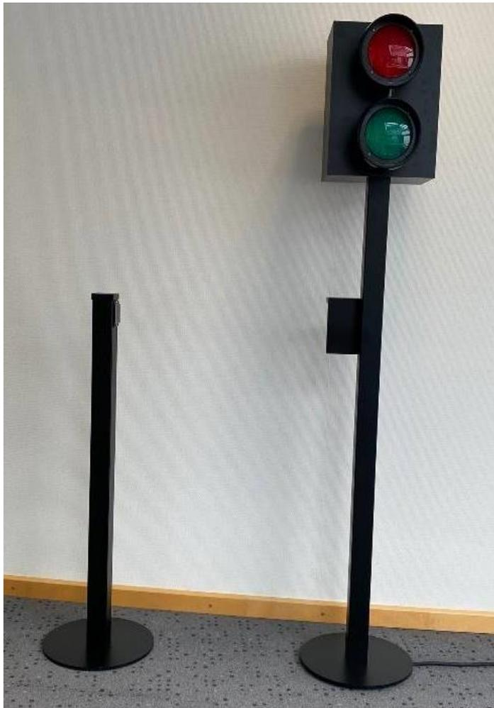
Am Eingang befindet sich eine Ampel mit Steuerung und Lichtschranke. Der Spiegel für die Lichtschranke befindet sich auf der gegenüberliegenden Seite der Türe.
